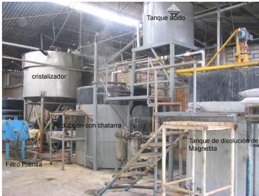
Planta para la obtención de Sulfato Ferroso a partir de concentrados de Magnetita
